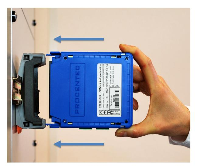
Fig. 20 - Inserting modules
