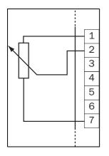
Fig. 13 10 k $\Omega$  potentiometer
