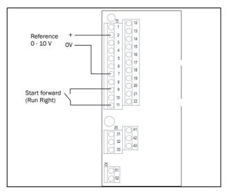
Fig. 14 Wiring
