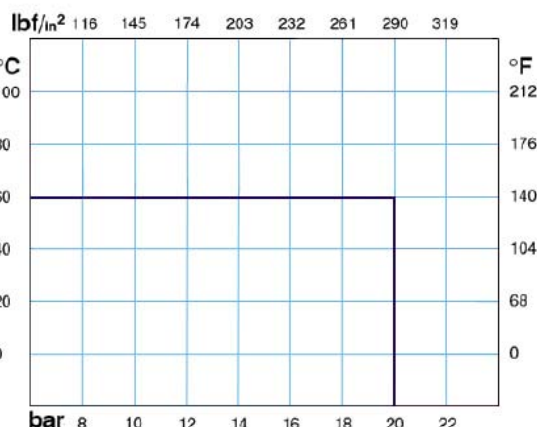
Réf. 1651 G : courbe Pression / Température Ref. 1651 G : Pressure / Temperature ratings
