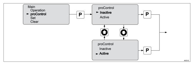
Fig. 14: Activate/deactivate control module delta®
