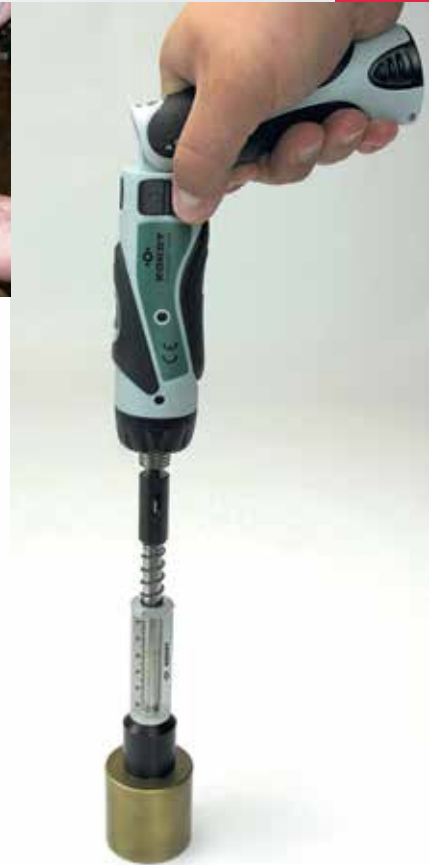
Oben: Automatische Gewindeprüfung mit Messung der Gewindetiefe (links 5319, rechts 5318)
