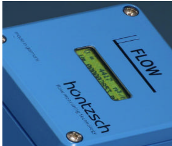
Abb. 2: optionale LCD-Anzeige im Gehäusedeckel
